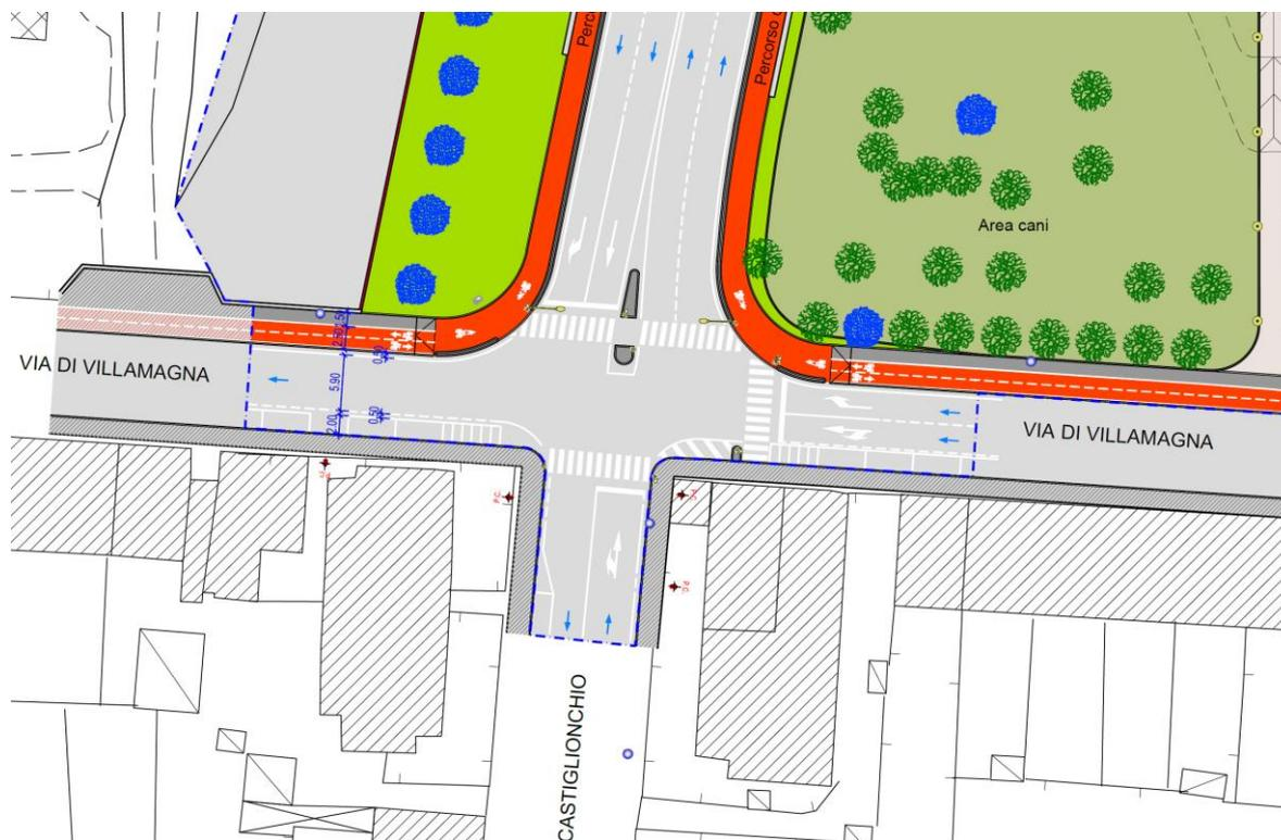
**Figura 4** – Sistemazione viaria prevista in progetto per il nodo via Villamagna – Via L. da Castiglionchio – Nuovo Ponte
