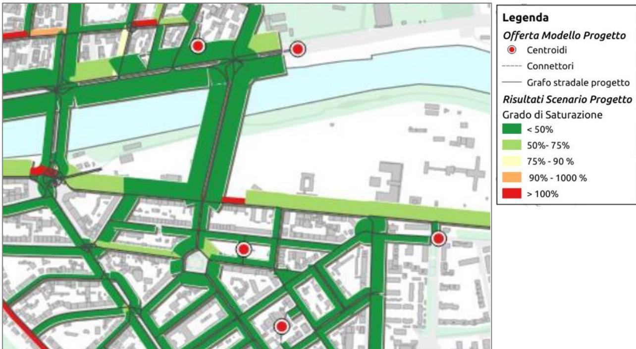
**Figura 3** - Grado di saturazione della rete allo stato di progetto ante-prescrizioni, dettaglio zona Nuovo Ponte (estratto da Figura 13 elaborato FL32-PD-STT-RL002-0A del Settembre 2019)
