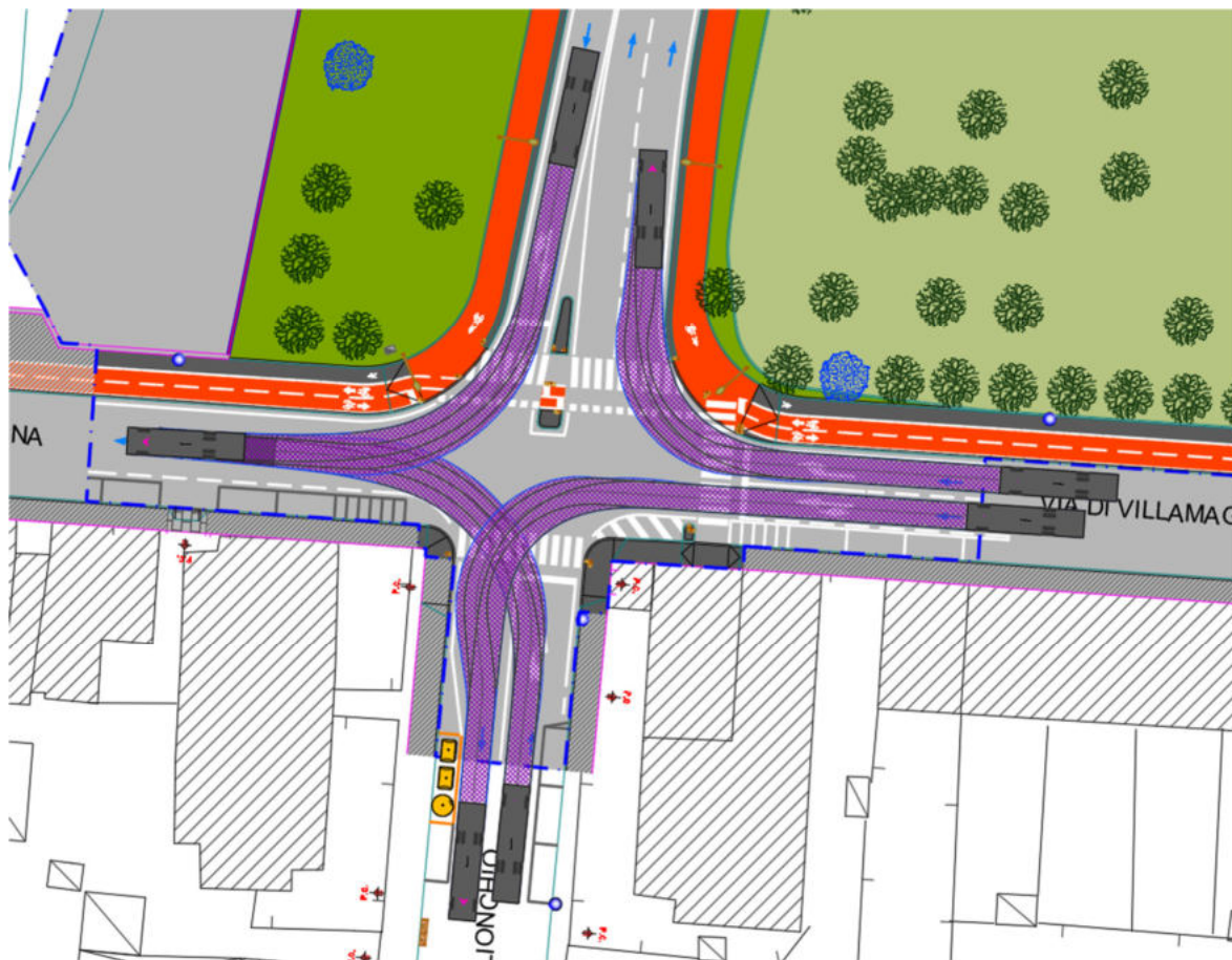
VV.FF. – Svolte incrocio via Villamagna – via Lapo da Castiglionchio – nuovo ponte Arno
