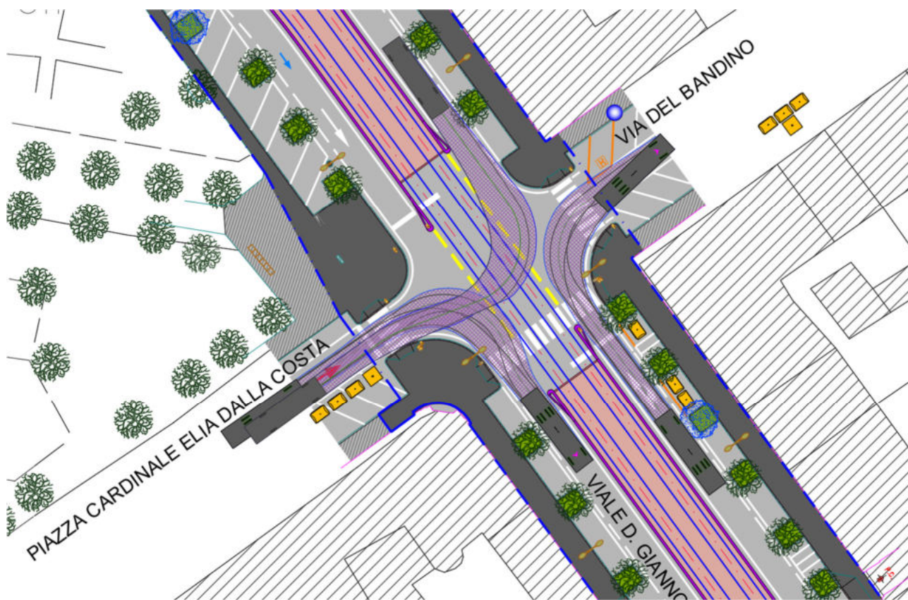
VV.FF. – Svolte zona incrocio viale Donato Giannotti – piazza Cardinale Elia dalla Costa – via del Bandino
