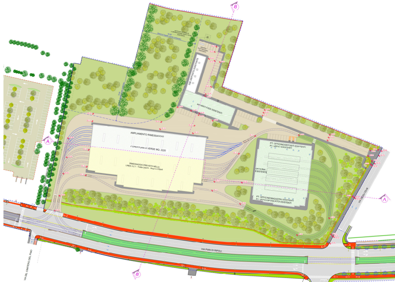
Planimetria generale dell'ampliamento del deposito tranviario
