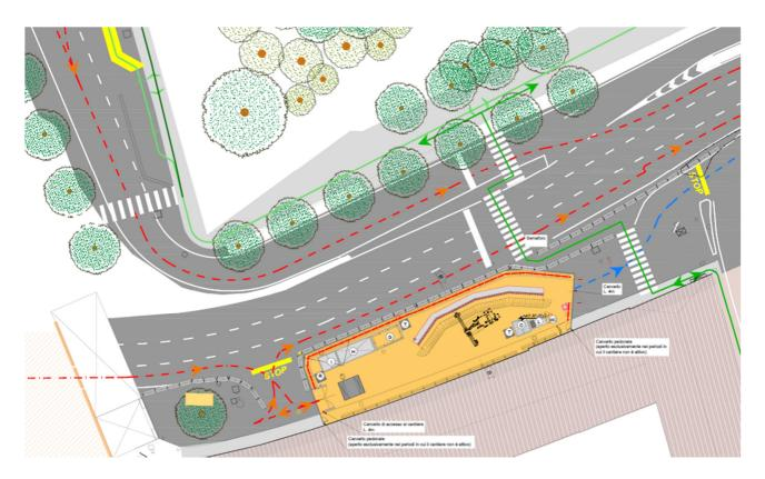
La sonda per le perforazioni lavorerà all'interno di una trincea di circa 1 m di profondità e le perforazioni saranno eseguite da un muro con funzione di dima, dal quale partiranno verso il bastione circa 45 canne per il consolidamento.
