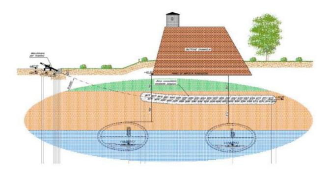
Le perforazioni saranno teleguidate in modo da garantire il corretto tracciato delle perforazioni e realizzare l'intervento mantenendo un'elevata precisione all'allineamento previsto. Per far ciò, saranno installate delle serpentine l'ungo l'asse tra i due cantieri Area 1 – Area 2 che creeranno il campo elettrico necessario per monitorare e controllare la direzione delle canne per il consolidamento.
