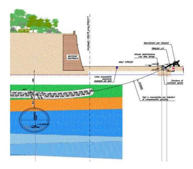
Le perforazioni saranno teleguidate in modo da garantire la corretta intercettazione del punto stabilito e realizzare l'intervento mantenendo un'elevata precisione all'allineamento previsto. Per far ciò, saranno installate delle serpentine l'ungo l'asse tra i due cantieri Area 3 – Area 4 che creeranno il campo elettrico necessario per monitorare e controllare la direzione delle canne per il consolidamento.
