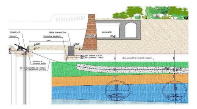
Le perforazioni saranno teleguidate in modo da garantire la corretta intercettazione del punto stabilito e realizzare l'intervento mantenendo un'elevata precisione all'allineamento previsto. Per far ciò, saranno installate delle serpentine l'ungo l'asse tra i due cantieri Area 3 – Area 4 che creeranno il campo elettrico necessario per monitorare e controllare la direzione delle canne per il consolidamento.
