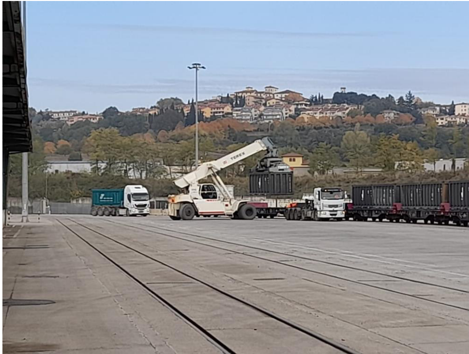
Foto 10 – Attività di scarico dei cassoni ferroviari con l'ausilio dei mezzi stacker
